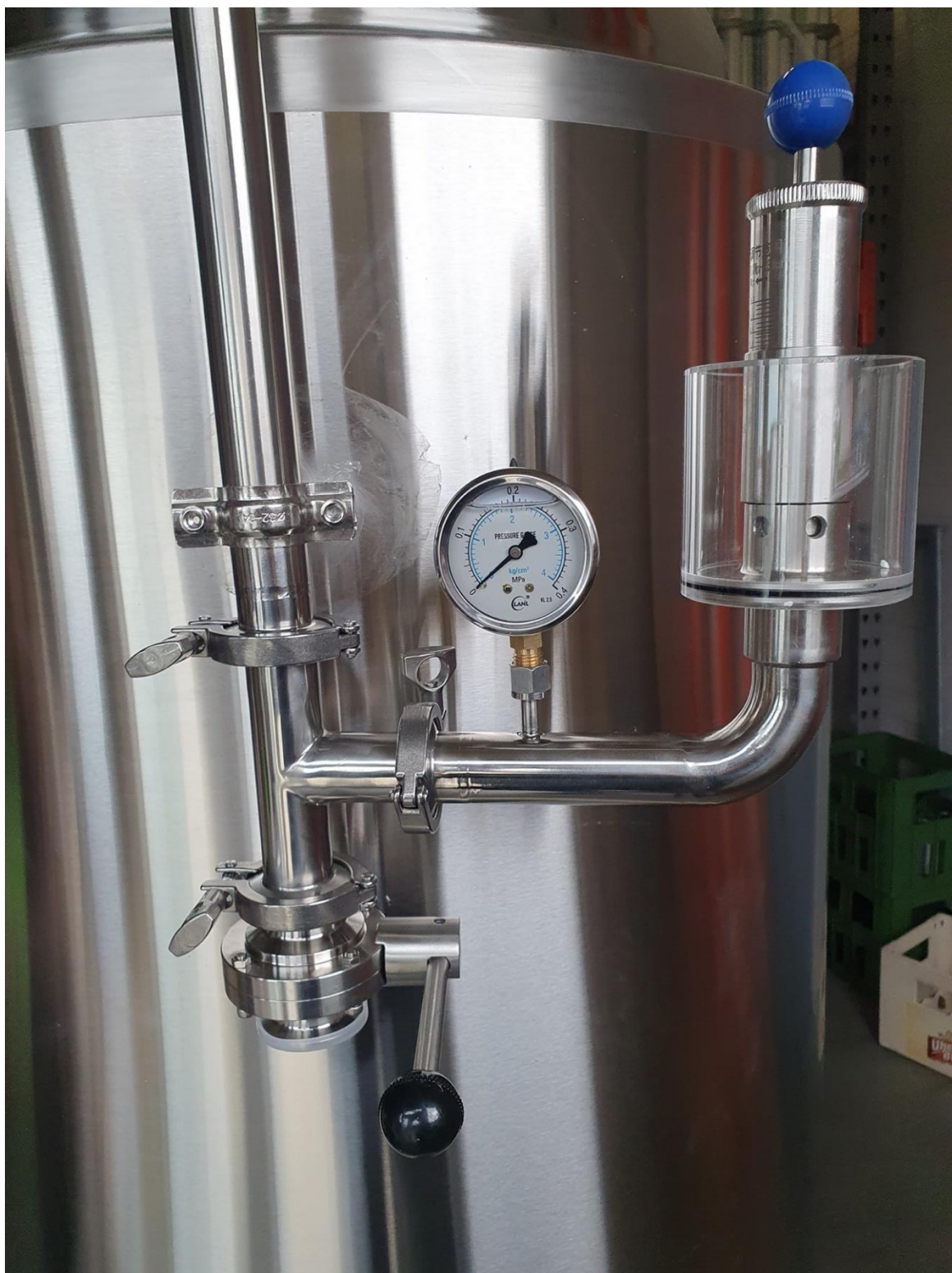
Hradicí soustava napojena na sanitační vedení, ventil v zavřené poloze. Požadovaný tlak nastavíte pomocí otočení válce s vroubkováním.
